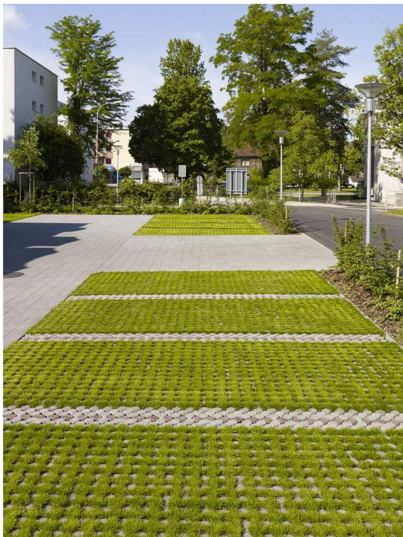
**Figura 20: Esempio di parcheggi con superficie drenante**
