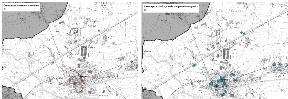
Misure impianti telecomunicazioni (centraline di rilevazione in continuo a sx; misure spot e con furgone del CEM a dx)
