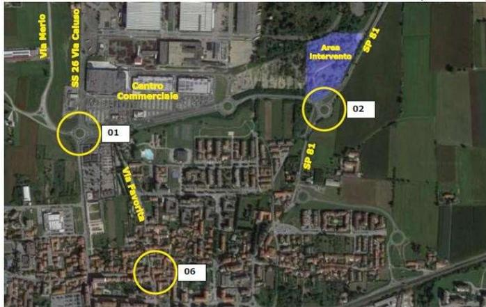
Figura 19 Postazioni di rilevamento del traffico veicolare
