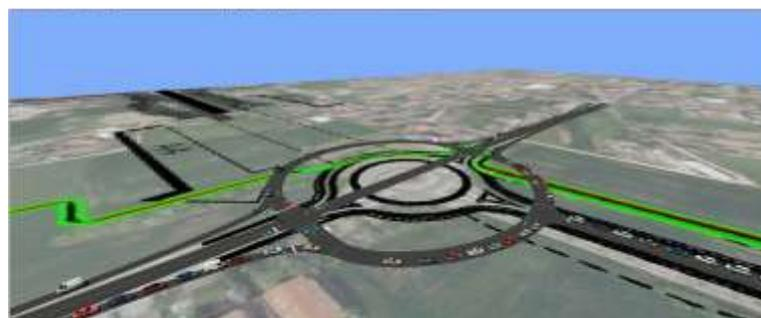
Il modello è in grado di **analizzare il funzionamento delle reti stradali, dei nodi, dei bracci e delle singole manovre di svolta** dei nodi e dei rami di svincolo, tenendo conto di vincoli quali la struttura delle corsie, la composizione del traffico, la regolamentazione degli incroci e delle rampe di svincolo, etc..
