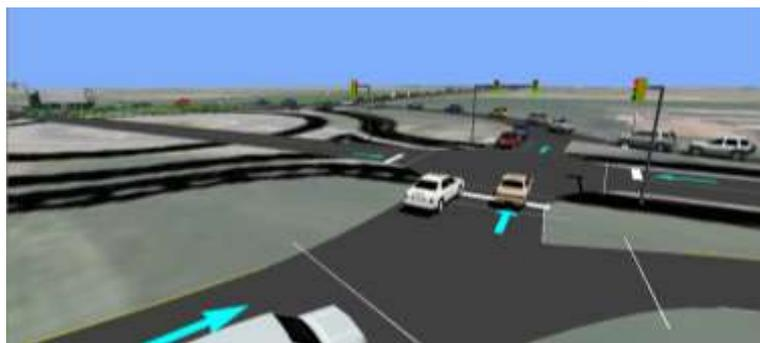
Il modello, opportunamente calibrato rispetto allo stato di fatto, Scenario 00 (do nothing), ha consentito di analizzare gli indici di performance a vari livelli di dettaglio: a livello di rete modellizzata, a livello di singola arteria, a livello di nodo, a livello di singolo braccio confluyente nel nodo, a livello di singolo movimento di svolta, etc..
