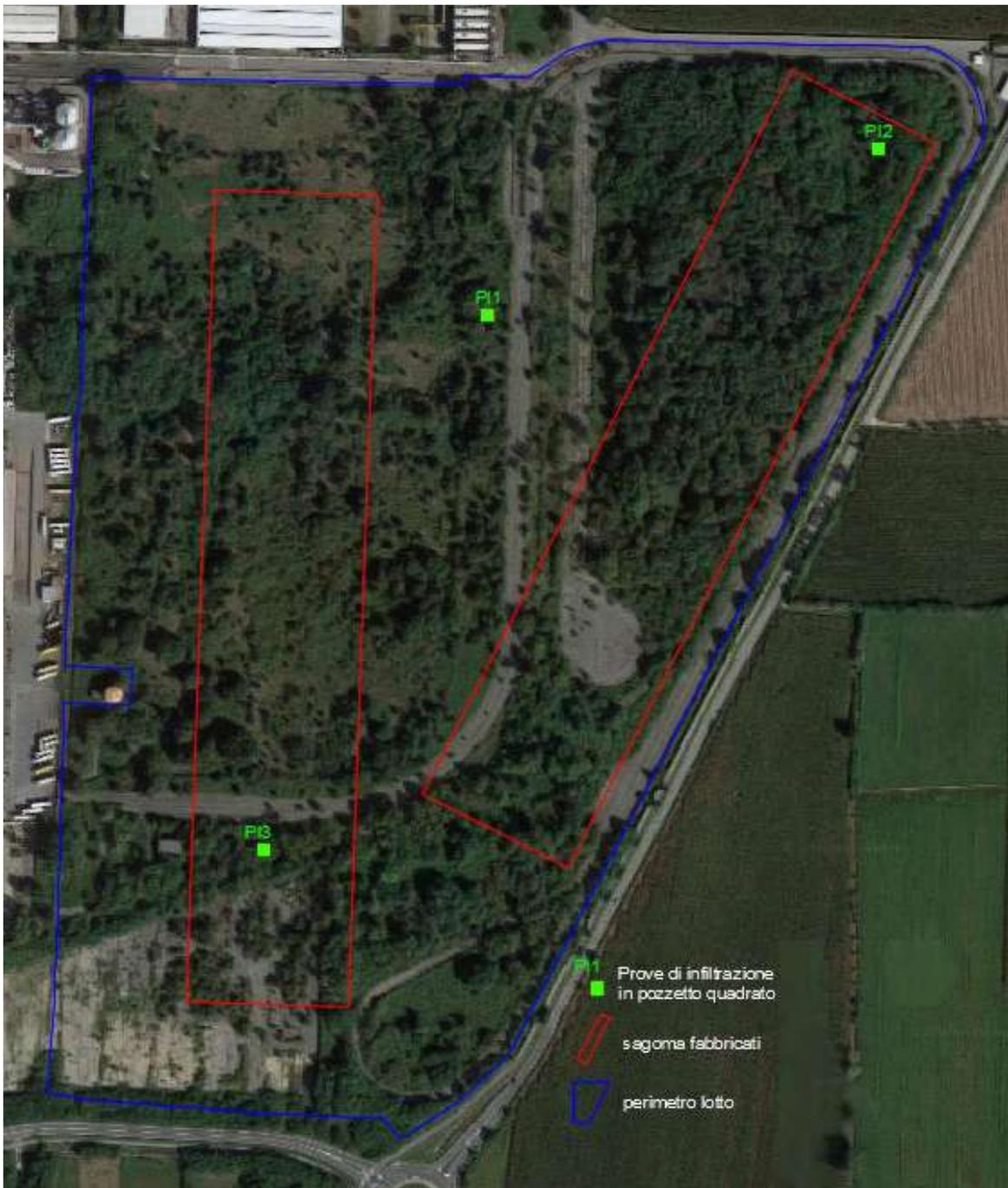
Interpretando i dati degli abbassamenti delle prove effettuate secondo i criteri per il calcolo della permeabilità in sito a carico variabile normati dall'AGI (1977) le prove effettuate hanno fornito i seguenti valori:
